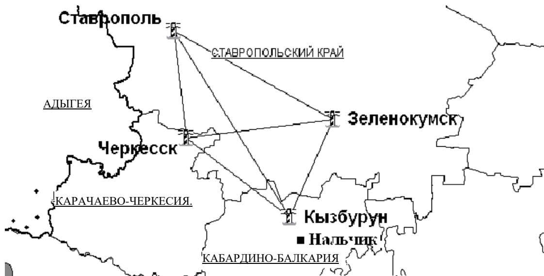
Рис. 1. Схема размещения грозопеленгаторов системы LS 8000 / Fig. 1. Scheme of placement of storm DF LS 8000
